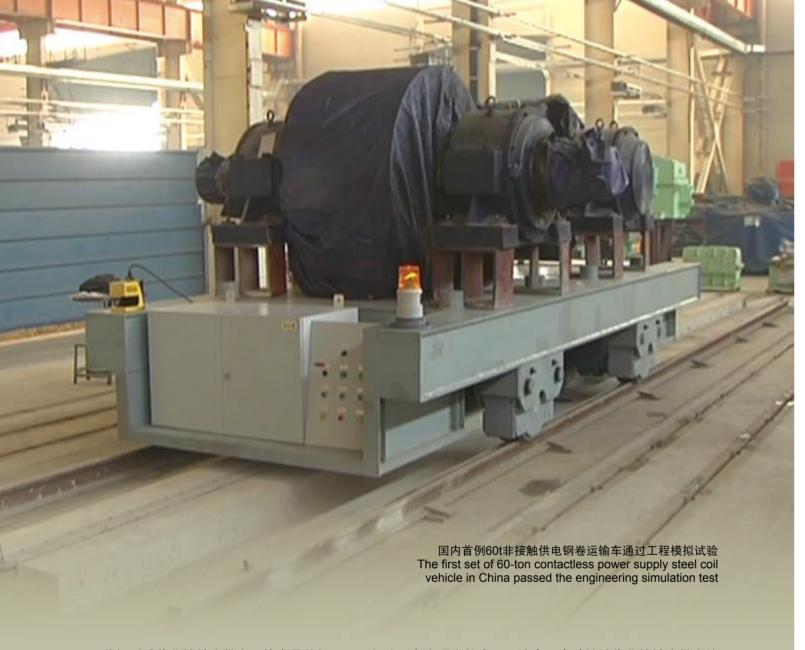
首钢型重载非接触式供电运输车是首钢国际工程公司自主研发的产品,该产品突破性地将非接触式供电技术应用到重载运输领域,很好地克服了传统重载运输设备移动供电的局限性,能够满足现代化工厂对运输系统可靠性、安全性及自动化程度日益增长的要求。
